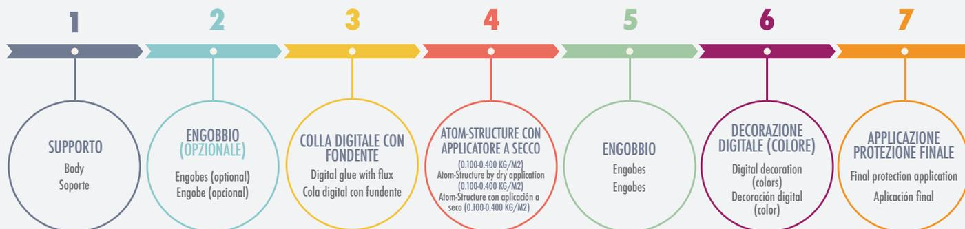
Colla digitale: testine ad alto scarico tipo L (Dimatix SG1024L, Seiko RC 1536L). L'applicazione di engobbio è opzionale a seconda del tipo di effetto desiderato.
