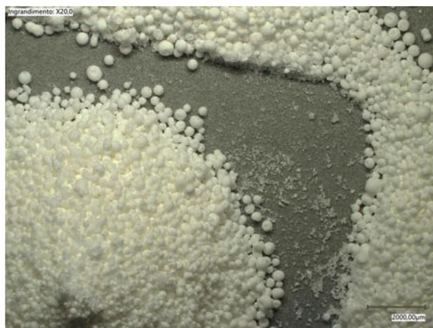
ATOM-STRUCTURE, es un producto atomizado calibrado que nace para ser aplicado al inicio de la línea de esmaltado, directamente sobre cola digital. ATOM-STRUCTURE sigue perfectamente el diseño de la cola, creando el relieve y la estructura deseadas. A continuación de la aplicación, se realizan después todas las fases habituales de la línea de producción. Según si se desea obtener un efecto más o menos marcado, Sicer propone 2 variantes: ATS010 e ATS020.
