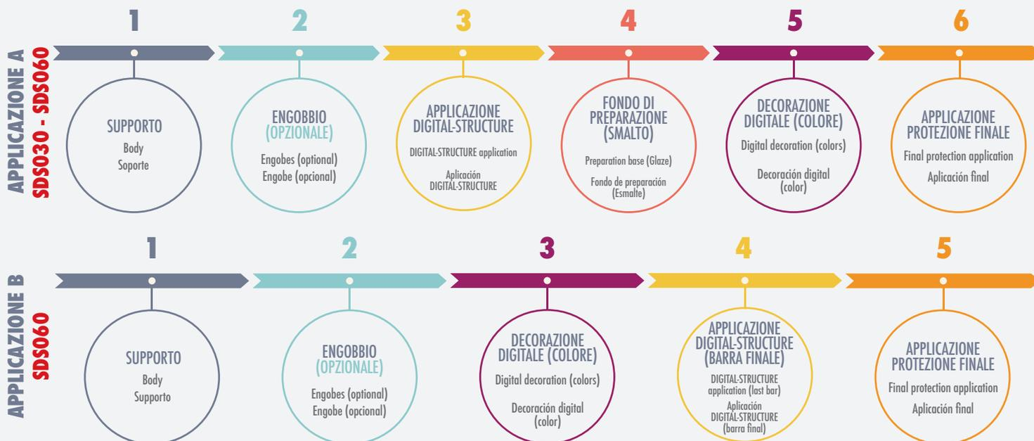
Colla digitale: Preferibile con testine ad alto scarico tipo L (Dimatix SG1024L, Seiko RC 1536L) - L'applicazione di engobbio è opzionale a seconda del tipo di effetto desiderato.
