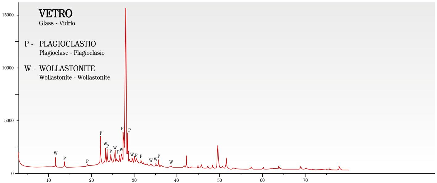
L'analisi a diffrazione a raggi X eseguita sulla superficie del prodotto realizzato con GHR mette in evidenza la presenza di questi **CRISTALLI**.
